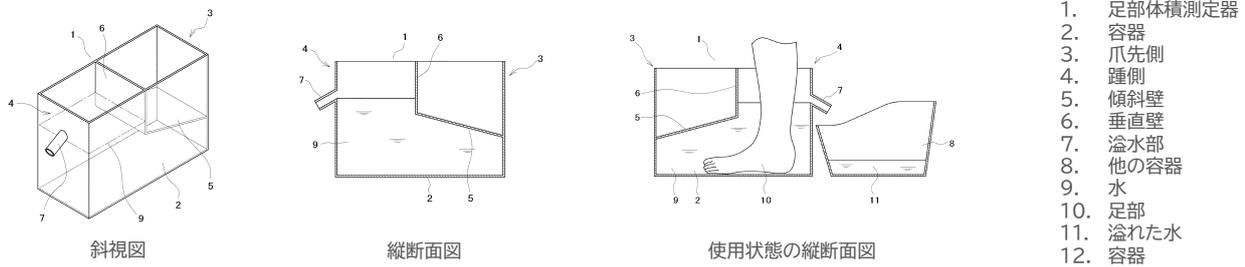
アルキメデスの原理を応用しており、**測定器に水を満たした状態で足を浸し、こぼれた水の重量を計測**します。測定原理および測定法が非常にシンプルであるため、容易に足関節体積の定量的評価を行うことが可能です。
